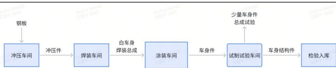
图 3.6-1 项目车身结构件总体制造工艺流程图
