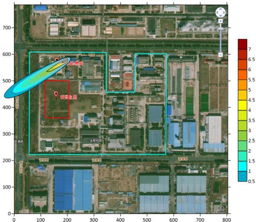
图6.2.5-4 氨氮连续泄漏含水层10年后浓度分布等值线
