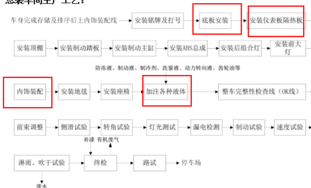
图 2-1 总装车间总体工艺流程图
